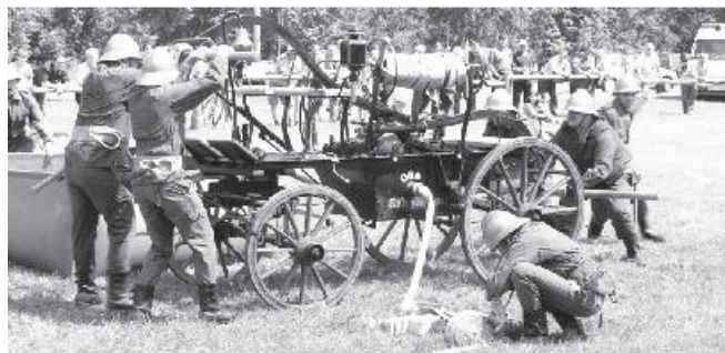
Sikawka ręczna czterokołowa o zaprzęgu konnym w czasie „akcji”
