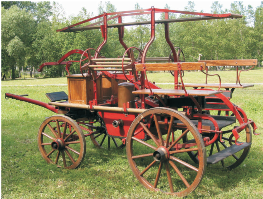
Sikawka czteroślowa ręczna o zaprzęgu konnym z dolnym zbiornikiem wodnym i zwijadłami ręcznymi
