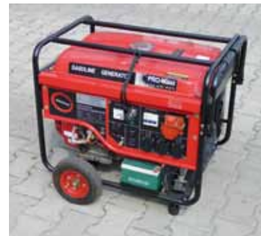
Agregat przeznaczony do awaryjnego zasilania respiratorów i koncentratorów tlenu
