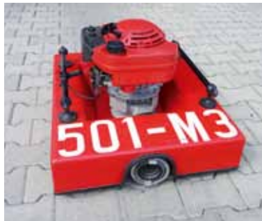
Motopompa pływająca – waga 28 kg
