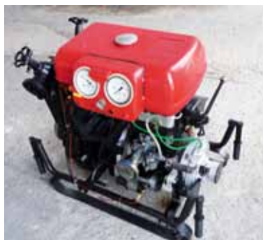
Motopompa pożarnicza Polonia PO 5 – waga 170 kg
