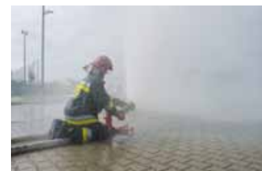
Działko wodno-pianowe wysokiej wydajności
